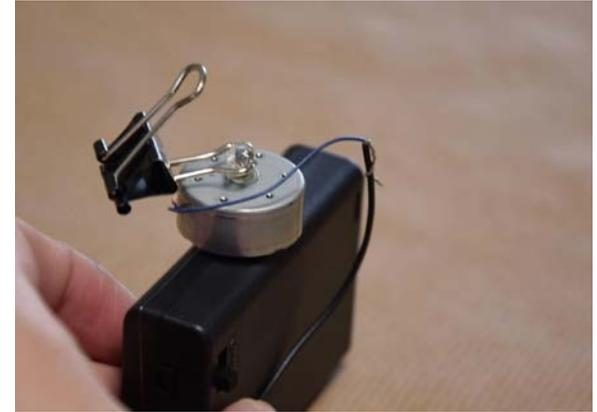
Klebe mit der Heissklebepistole den Motor oben auf den Batteriehalter. Pass dabei gut auf deine Finger auf!!!
